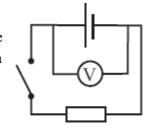
15. Когда цепь разомкнута, идеальный вольтметр показывает 8 В. При замкнутой цепи вольтметр показывает 7 В. Сопротивление внешней цепи равно 3,5 Ом. Чему равен ток короткого замыкания?
